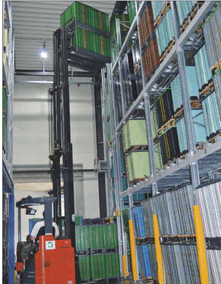
Rund neun Meter hoch sind die Hochregallager im LDZ: Die oberste Ebene erreichen nur die Schubmast-Stapler. (Foto: ÖGW)
