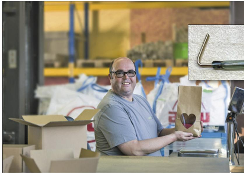
*Die Simotec ist Spezialist für Verpackung und Montage (großes Bild). Der Reed-Kontakt besteht aus zwei Kontaktzungen, die in einem Glasröhrchen eingeschlossen sind (kleines Bild). (Fotos: ÖGW)*
